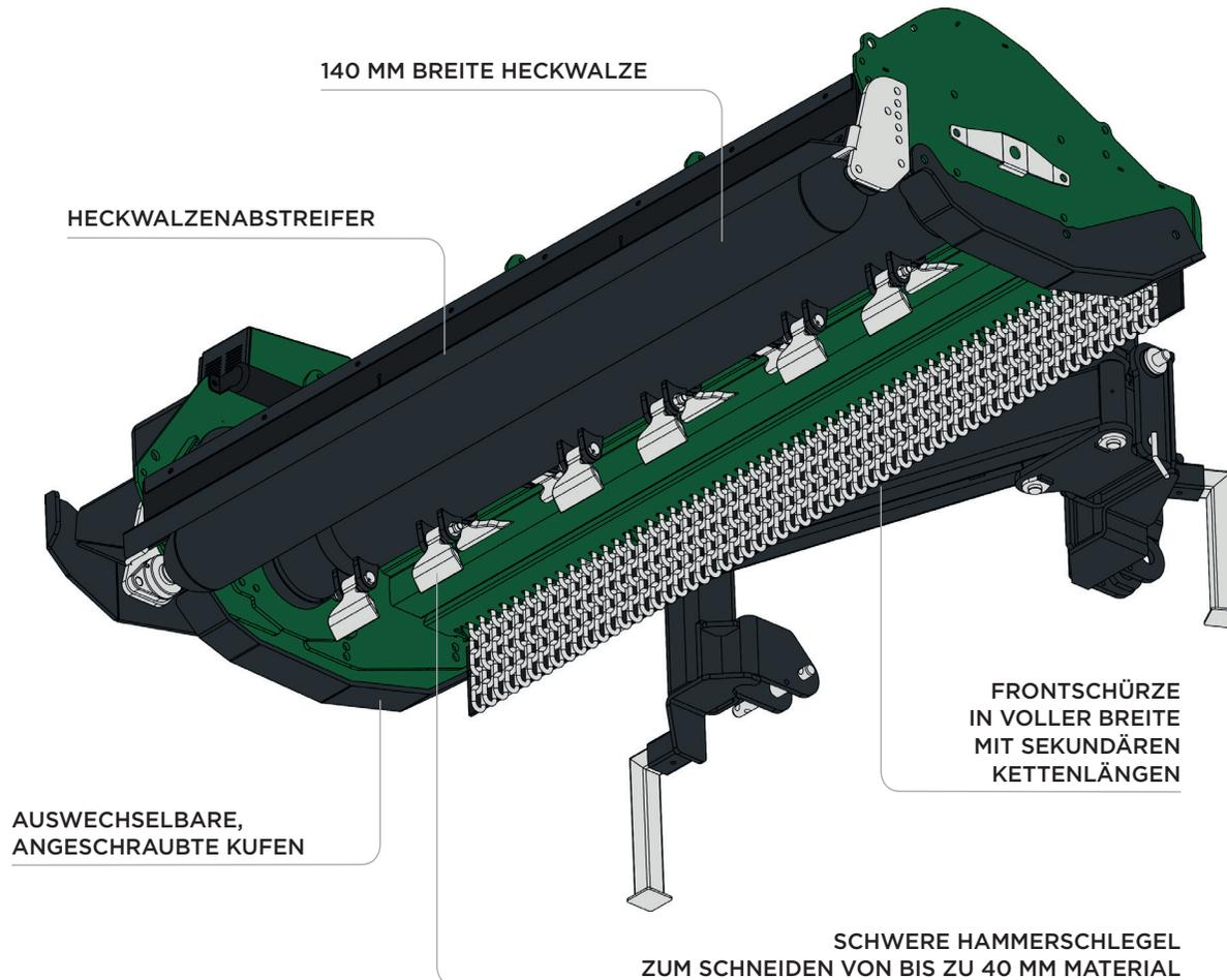
Der Sniper Offset-Schlegelmäher ist für den Einsatz an Böschungen und Hängen konzipiert und bietet eine hohe Qualität und einen gleichmäßigen Schnitt bei Material bis zu 40 mm. Es ist die perfekte Wahl für die Pflege und Instandhaltung von Pflanzbereichen an Wasserstraßen und Autobahnen.
