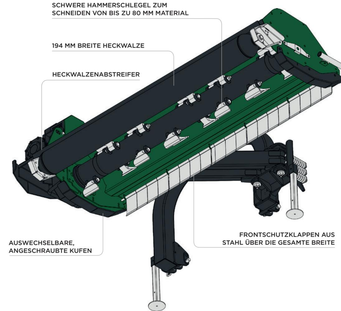
Der Sniper HD Offset-Schlegelmäher ist für den Einsatz an steilen Böschungen und Hängen konzipiert und bietet eine hohe Qualität und einen gleichmäßigen Schnitt bei Material bis zu 80 mm. Es ist die perfekte Wahl für die Pflege und Instandhaltung von Pflanzbereichen an Wasserstraßen, Autobahnen und stark überwucherten Gestrüppen.
